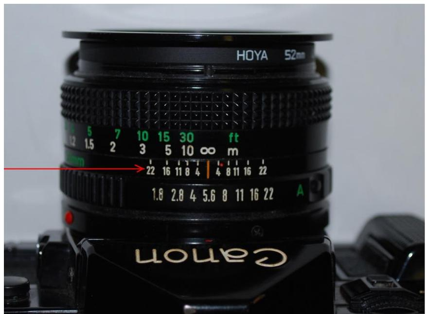
Sur l'objectif entre la bague des diaphragmes et celle des distances se trouve une échelle fixe qui représente les ouvertures. Elle vous permet de visualiser la profondeur de champ en fonction de l'ouverture. Ici à  $f/8$  la profondeur de champ va de 10m à l'infini, à  $f/22$  elle va de plus ou moins 4m à l'infini.
