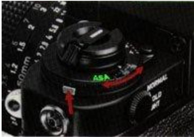
Tout en appuyant sur son bouton de déblocage tourner le sélecteur de sensibilité jusqu'à placer la valeur correcte du film mis dans l'appareil en regard de l'index. Les limites de l'échelle de sensibilité vont de 6 à 640 ASA/ISO.
