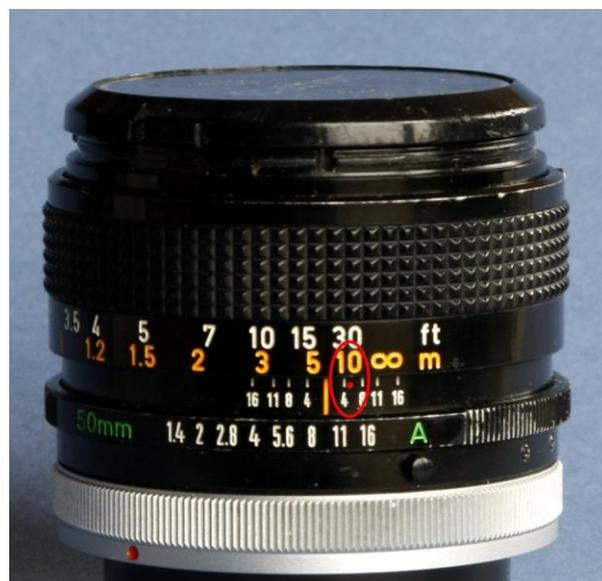
Pour la photographie sur film infrarouge, une correction de la distance de mise au point s'impose du fait que la longueur d'onde des rayons infrarouges diffère légèrement de celle des rayons visibles.
