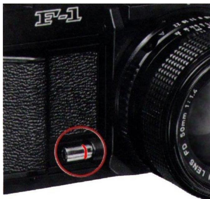
5- La vitesse d'obturation est automatiquement déterminée par l'appareil en fonction de l'ouverture réglée sur l'objectif.
