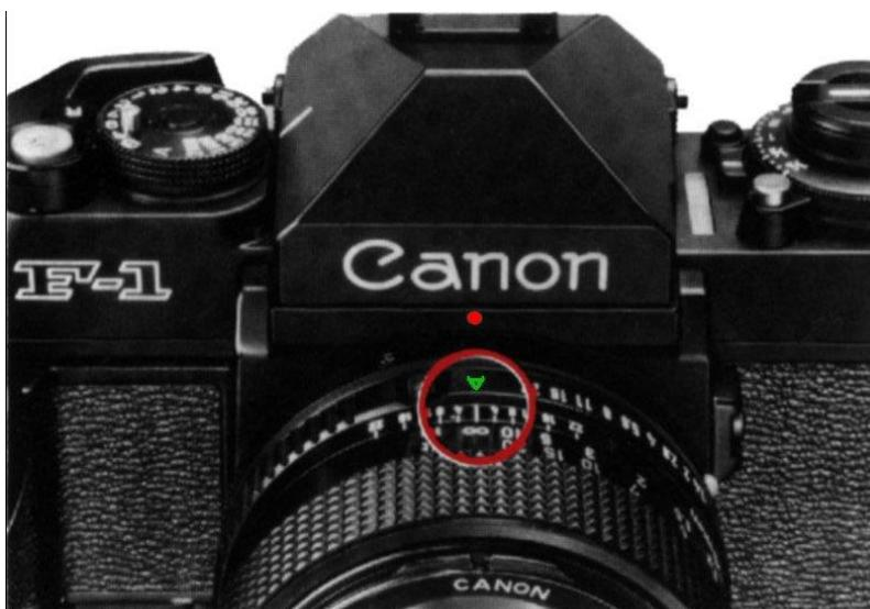
L'échelle des ouvertures et l'affichage de la vitesse d'obturation apparaissent dans le viseur, tout comme en mesure par superposition d'aiguilles, à droite du champ de l'image. Cependant, l'aiguille suiveuse disparaît. Lorsqu'on pousse le déclencheur à mi-course, l'aiguille du posemètre marque automatiquement l'ouverture choisie par l'appareil.
